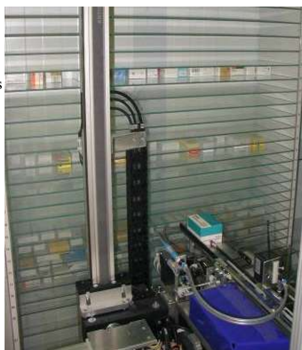
Récupération et positionnement des boîtes par le bras articulé de Mach4
