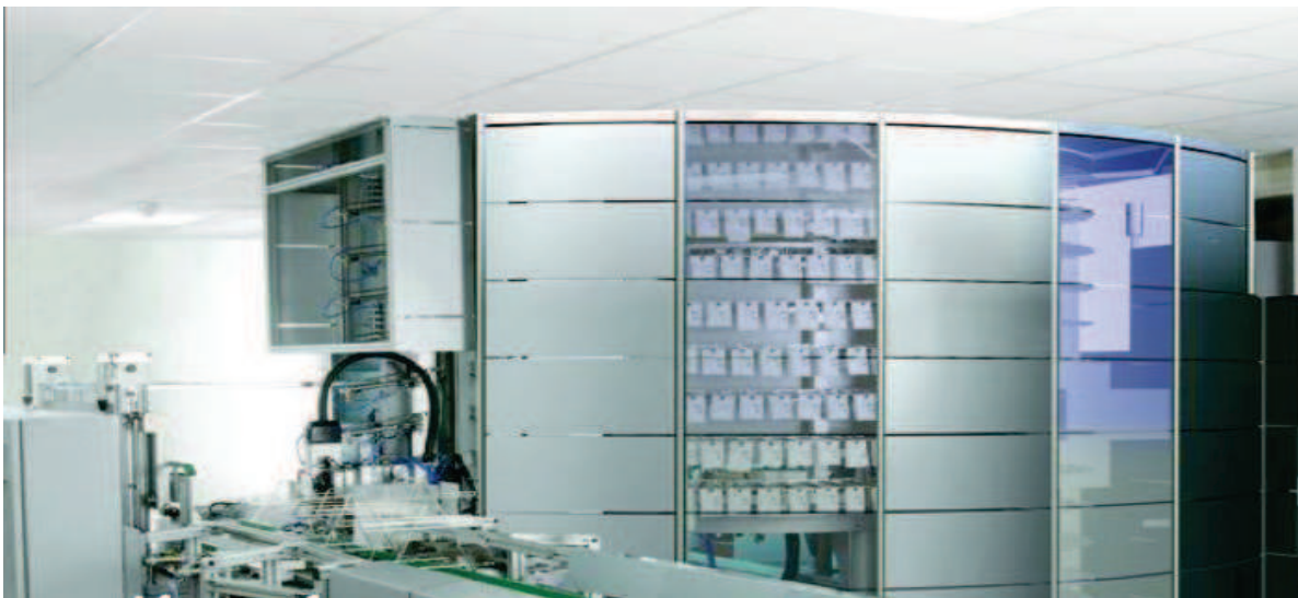
Système HOMERUS de France Hôpital, module stockant les sachets de médicaments surconditionnés.
