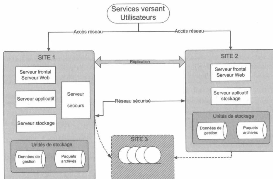
Figure 5 : Exemple d'architecture technique du SAE
