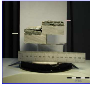
Figures 56, 56' & 56'' – Surface de l'alliage 2024T3 exposé 1 à 24 mois EM sens L. TL
