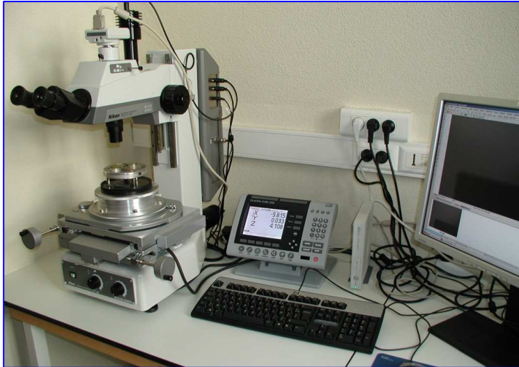
Figure 133 – Microscope de mesures avec ordinateur et logiciel d'analyse d'images.
