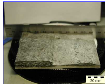
Figures 59, 59' & 59'' - Surface de l'alliage 2198T3 exposé 1 - 24 mois EM sens L. TL.
