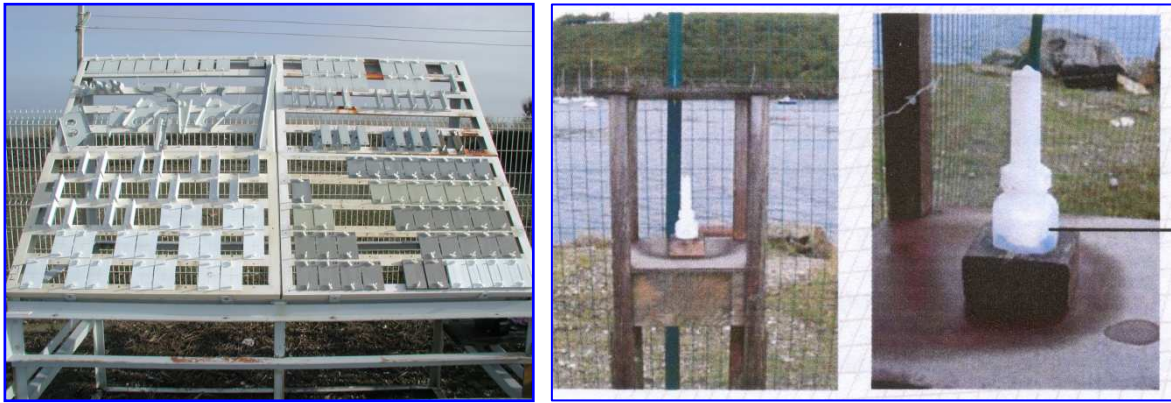
Figure 45 - Support échantillons et chandelle humide.
