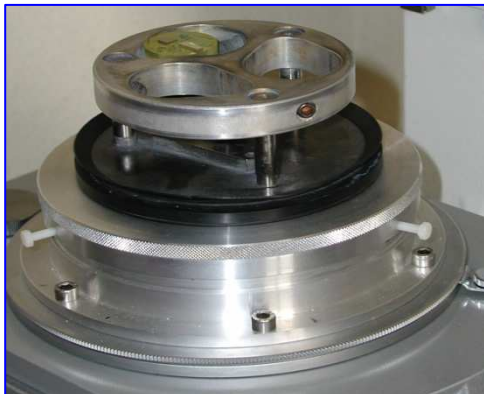
Figure 137 - Ensemble porte-échantillon et adaptation mécanique.
