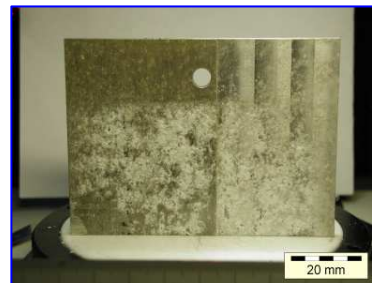
Figures 62, 62' & 62'' - Surface de l'alliage 2198T8 exposé 1 - 24 mois EM sens L, TL.
