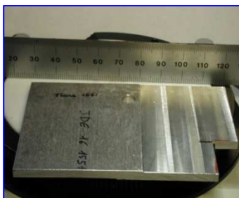
Figures 59, 59' & 59'' - Surface de l'alliage 2198T3 exposé 1 - 24 mois EM sens L. TL.
