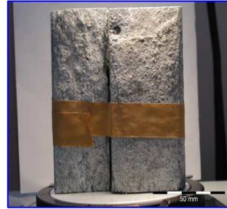
Figures 56, 56' & 56'' – Surface de l'alliage 2024T3 exposé 1 à 24 mois EM sens L. TL
