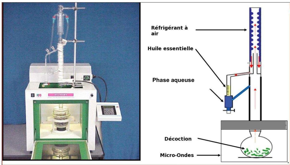
Figure 6 : montage d'une distillation assistée par micro-ondes.
