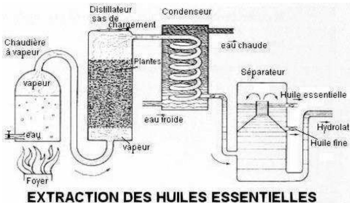
**Figure 5 : Procédé d'extraction des HE par entraînement à la vapeur.
