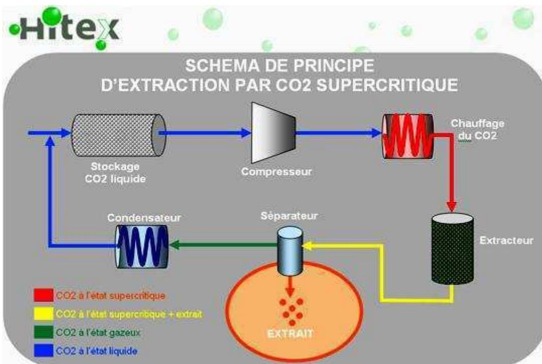
Figure 8 : schéma de principe d'extraction par CO<sub>2</sub> supercritique. (Société Hitex)
