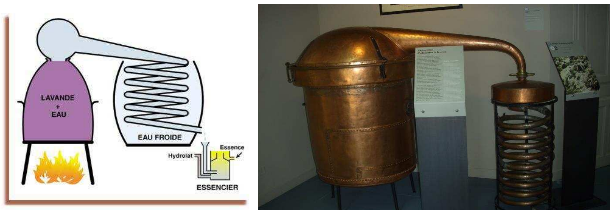
Figure 28 : Alambic simple à feu nu mobile. [14]
