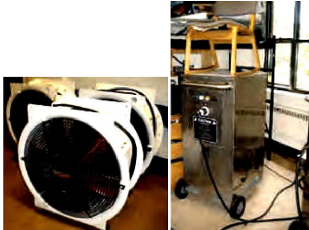
Figure 36 : ventilateurs à convection et réchauffeurs électriques utilisés dans le traitement thermique (73) (Source : Department of Entomology, Virginia Tech)
