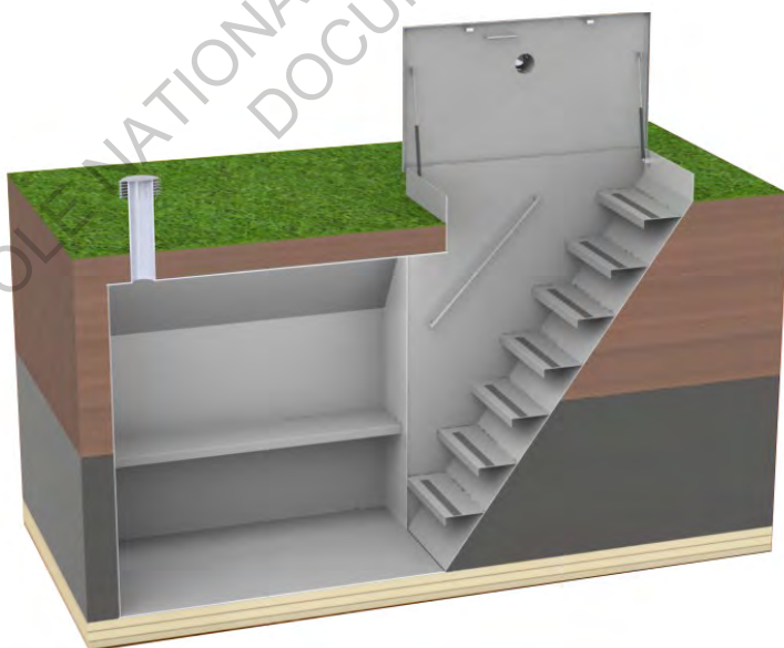
Figure 28 : Exemple d'abris de tornades «Storm shelters»
