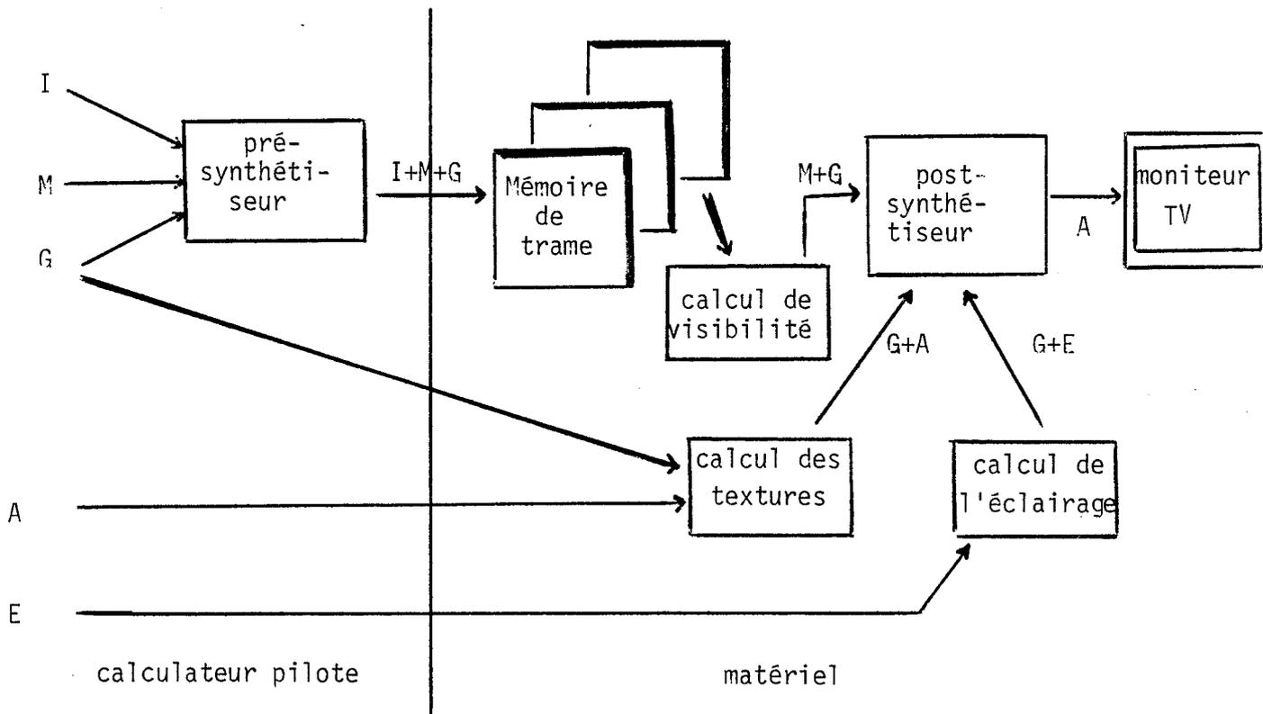
Figure 23 - Schéma de la synthèse sur HELIOS
