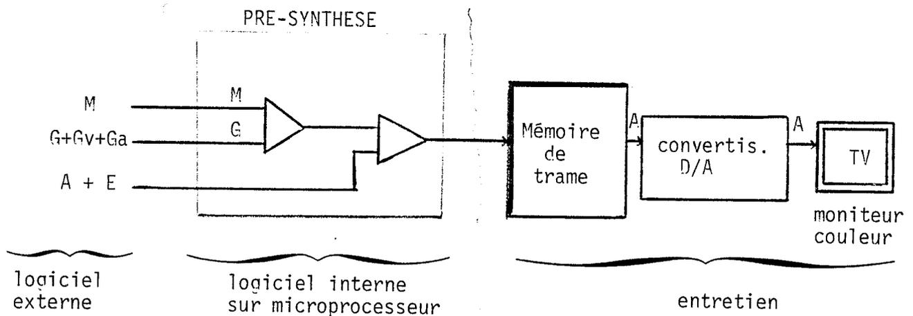
Figure 19 - Structure du 4027 de TEKTRONIX
