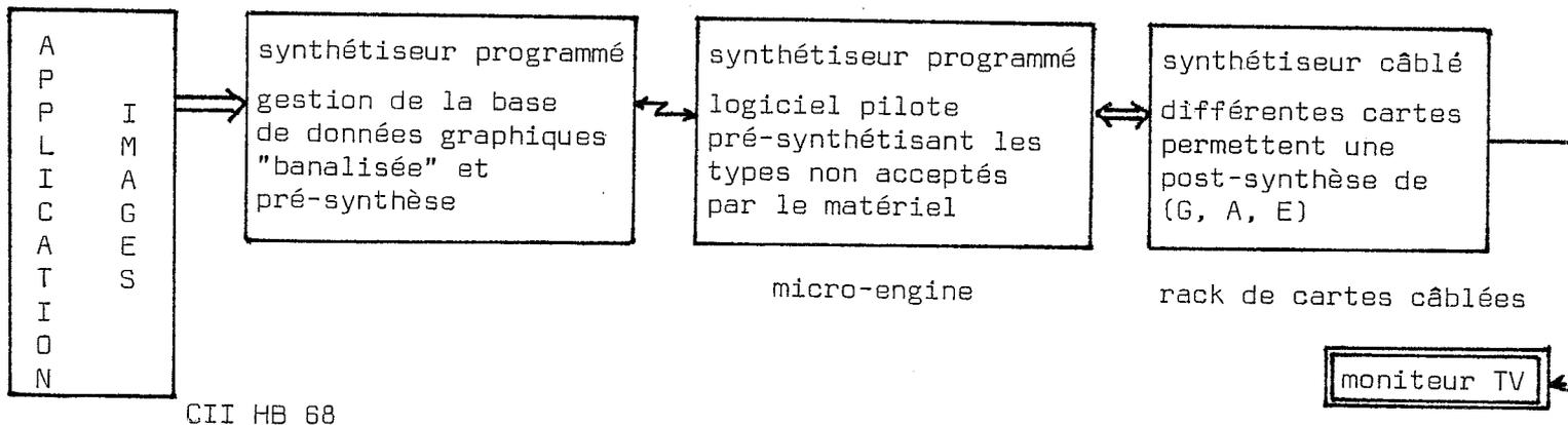
Figure 24 - HELIOS : un système composé de trois synthétiseurs
