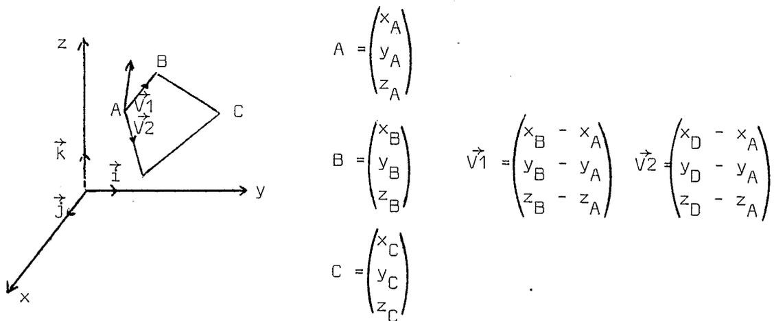
Figure 78 - Les vecteurs de base  $\vec{V}_1$  et  $\vec{V}_2$
