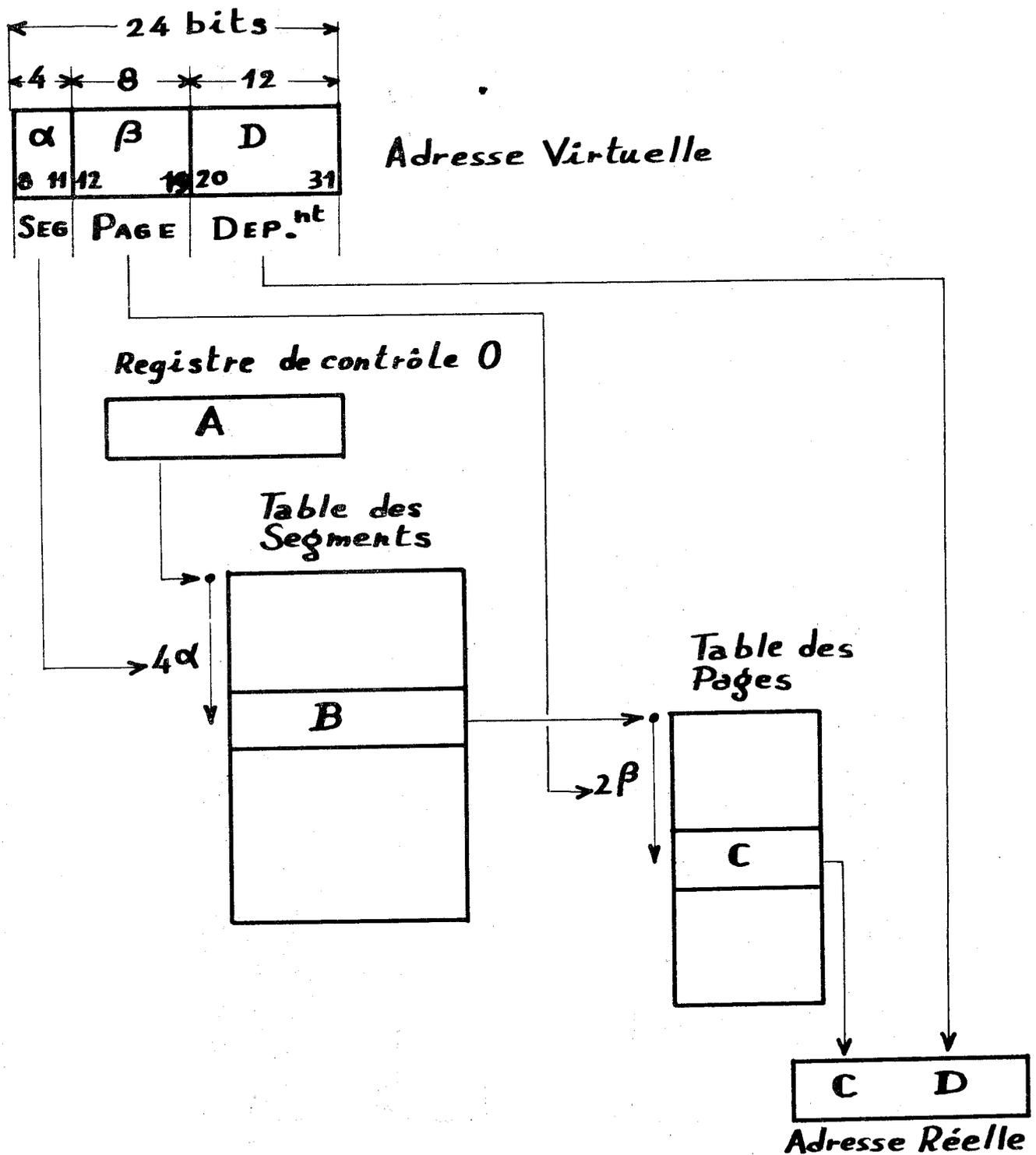
Figure 2.1.3(d) Calcul d'une adresse Réelle .
