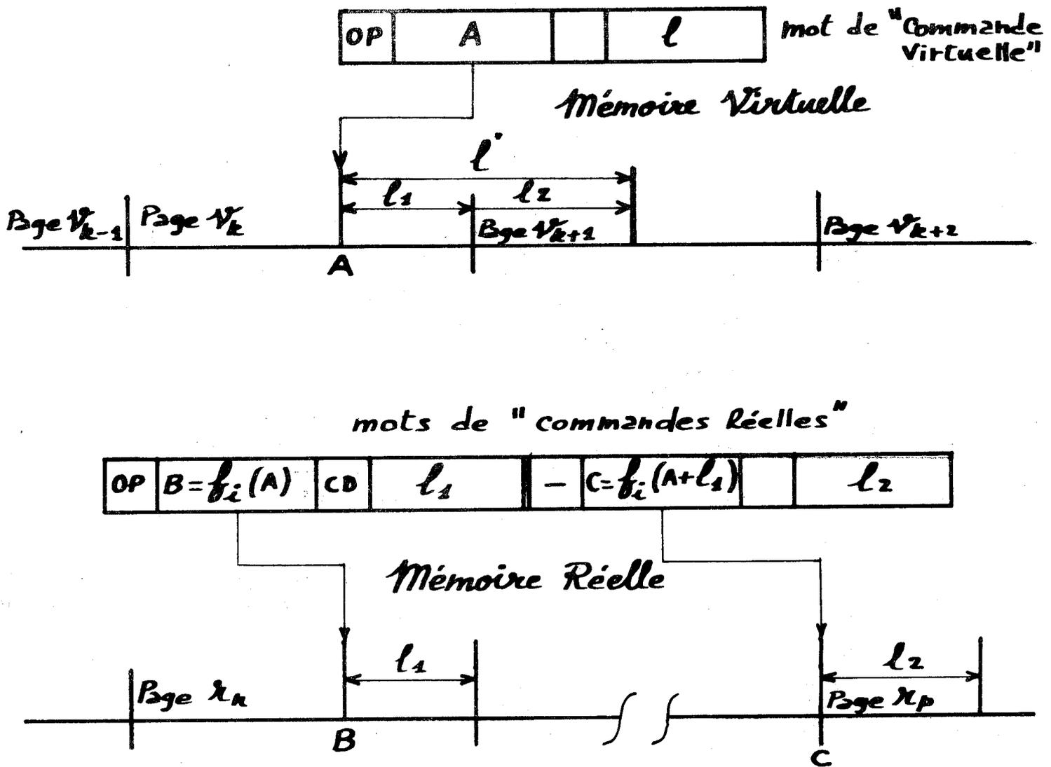
Figure 2.2.2(d) Transformation d'un mot de commande virtuelle en deux mots de commandes réelles .
