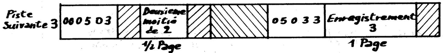
Figure 2.2.1(b) Les pistes 2 et 3 du cylindre 5 par exemple .
