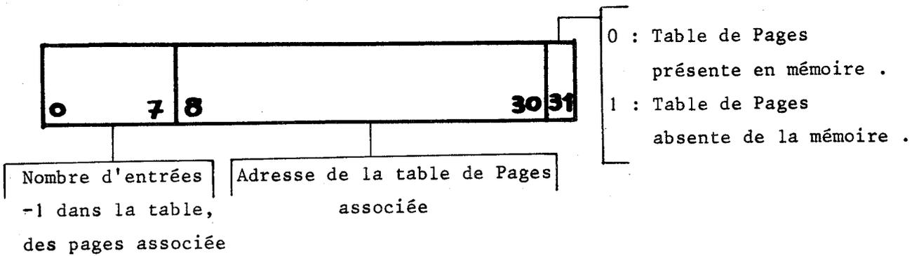
Figure 2.1.3(b) Une entrée de la table des Segments .
