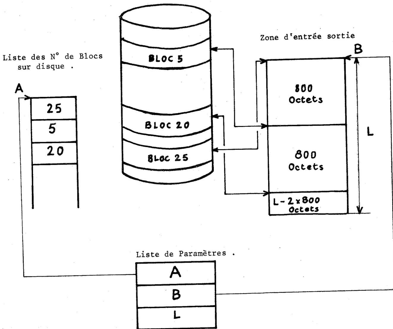
Figure 3.3(a) Exemple d'Entrée-Sortie CMS , sur Disque .
