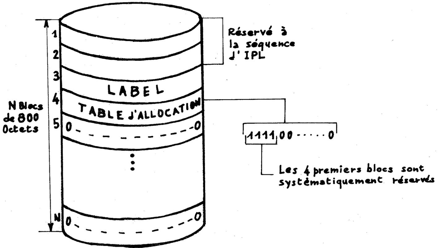
Figure 2.2.3(a) Structure d'un Disque CMS nouvellement initialisé .
