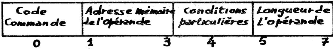
Figure 2.2.2(a) Une commande Canal .
