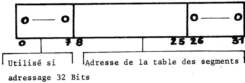
Figure 2.1.3(a) Le Registre de contrôle 0 .
