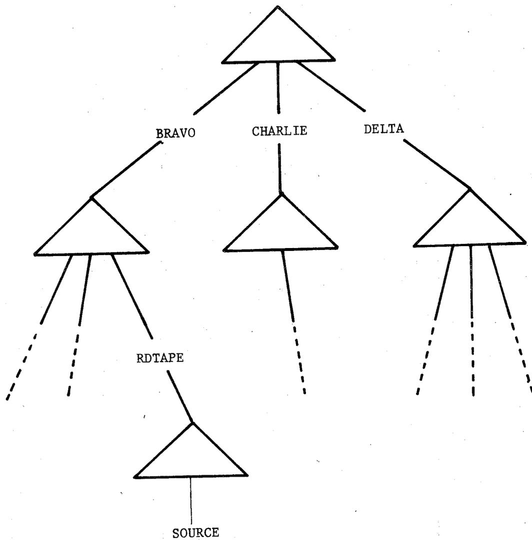
Figure 4.3.1(c) Exemple de Catalogue d'un F-Espace Multi-Utilisateur .
