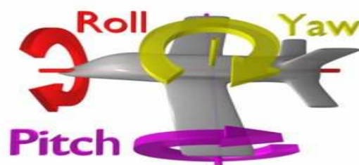
Figure 45 : Mise en lumière du tangage du roulis et du lacet dans un espace de dimension 3.
