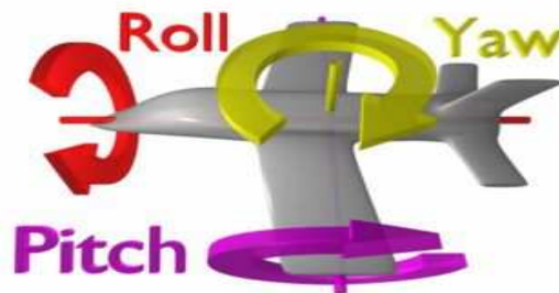
Figure 65 : Mise en lumière du tangage du roulis et du lacet dans un espace de dimension 3.
