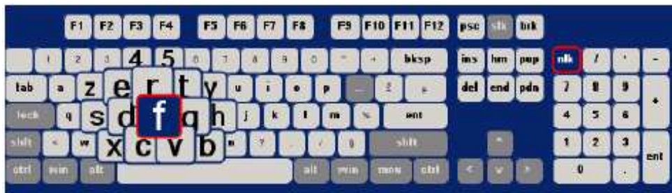
Figure 117 : Clavier actif « FishEye », le pointeur du dispositif de pointage se trouve à proximité du caractère F.
