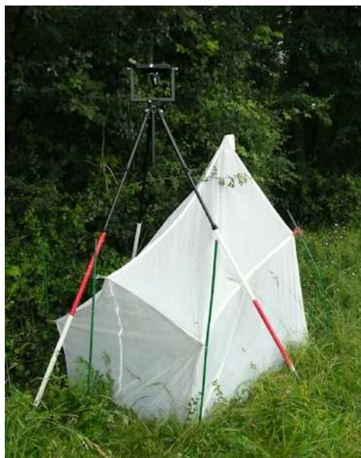
Figure 5 : Dispositif mis en place pour la prise d'une photographie hémisphérique en lisière. Bois de Labroquère.
