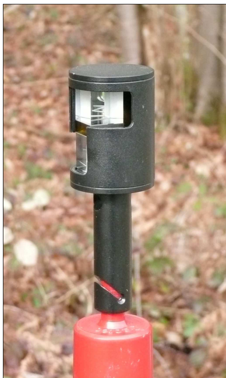
Figure 1 : Equerre optique permettant de visualiser un point à 90° d'une ligne droite de référence.
