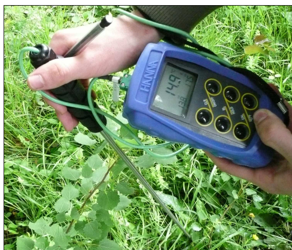
Figure 3 : Mesure de la température avec un thermomètre à thermocouple en lisière du bois de Labroquère.
