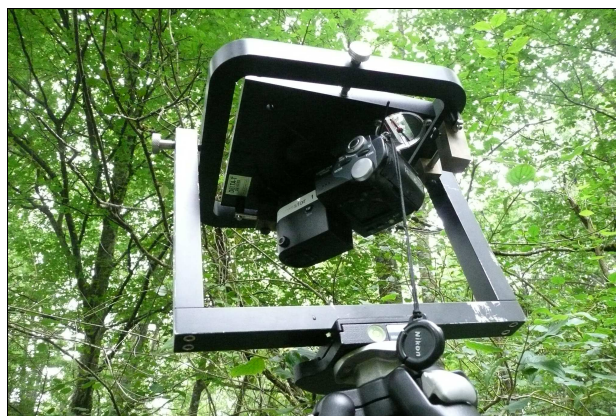
Figure 2 : Appareil photographique fixé au trépied surmonté d'un objectif semi-circulaire pour la prise de photographies hémisphériques. Bois de Labroquère.
