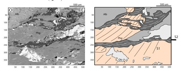
**Figure 14**: image RX des variations de Si (brute : blanc = nb de coups élevé ; Noir = Nb de coups faible) dans le granite de Plan de Phasy. Les phengites D1 sont reprises par un cisaillement D2 associé à la cristallisation des chlorites.
