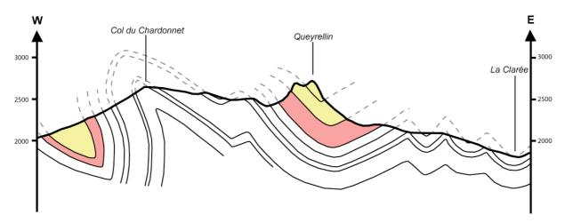
**FIGURE 8**: Coupe structurale 1:1 du vallon du Chardonnet. La position de la coupe est localisée sur la fig. 3. Les terrains Westphaliens sont représentés en blanc, les terrains Werfénien à Stéphaniens en rouge et les séries mésozoïques en jaune. La partie à l'Est du Queyrellin représente la zone à plis droits non déversés de Fabre et al., (1982).
