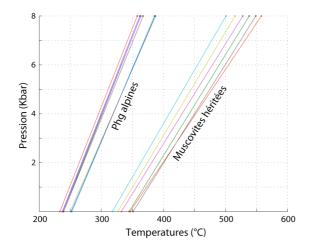
FIGURE 18: Droites d'équilibres Micas + Quartz + eau (variation de l'hydratation du mica) pour les micas de la Clarée. On trouve deux familles de droite, l'une avec des températures élevées et l'autre avec des températures faibles à pression constante.
