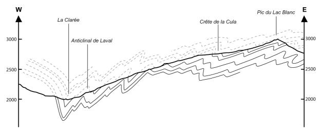
**FIGURE 9**: Coupe structurale 1:1 de Laval (rive gauche de la Clarée). La coupe est localisée sur la fig. 3. Les terrains Westphaliens sont représentés en blanc. La partie Clarée – Laval représente la zone partiellement déversée définie Fabre et al., (1982) et la zone Cula – Lac Blanc, la zone fortement déversée vers l'Est.
