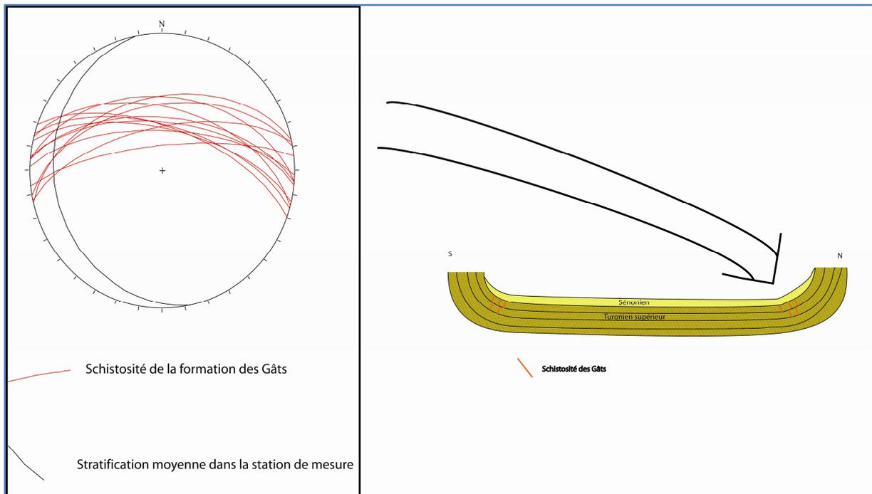
**Fig 3.8 : Stéréogramme (Wulff inférieur) de la schistosité de la formation des Gâts sur le flanc nord du synclinal de Glandage**
