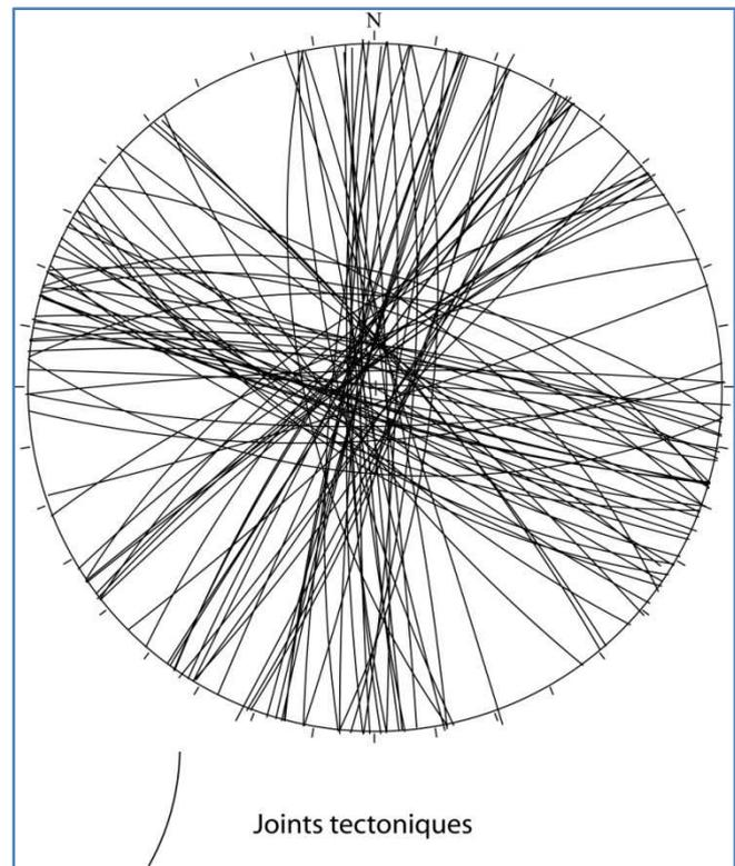
**Fig 3.3 b : Stéréogramme (Wulf inférieur) représentant des joints tectoniques pour les 36 stations dont la stratification a été mise à plat**
