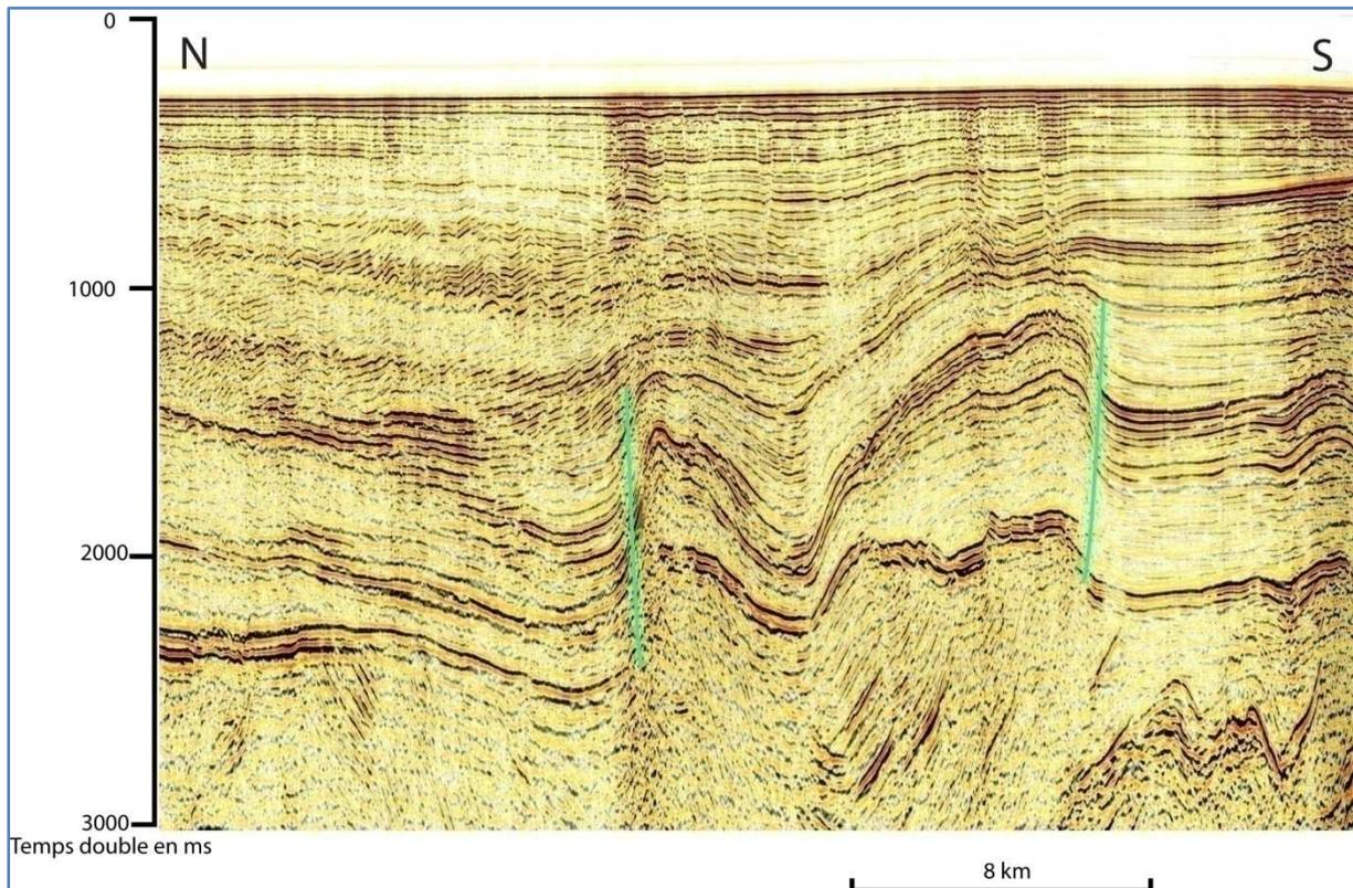
**Fig 6.1 : Profil sismique d'une inversion structurale**
