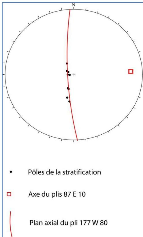
**Fig 4.9 : Stéréogramme (Wulff inférieur) du pli renversé au col des Vautes**
