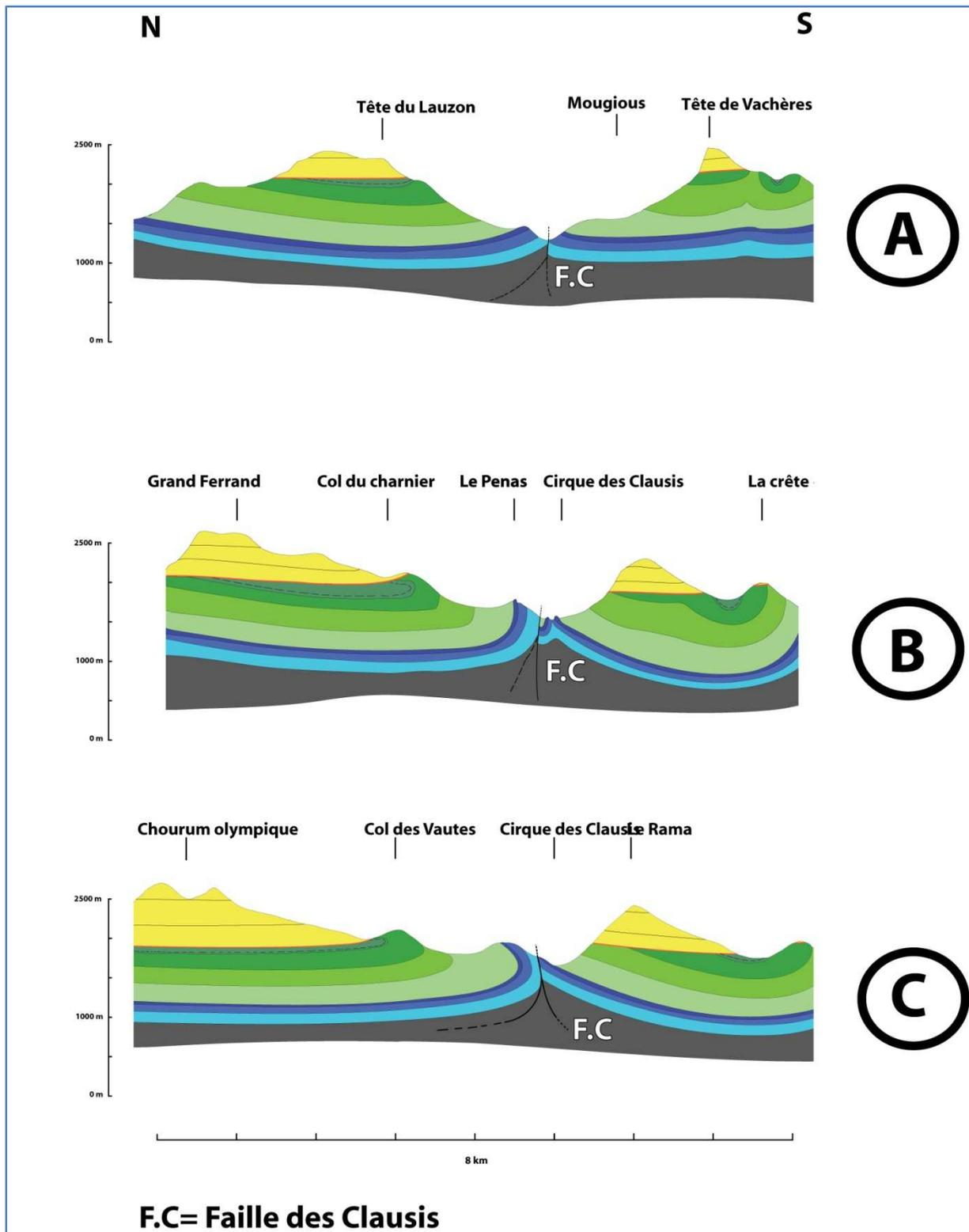
*Fig 4.2 : Coupes structurales de la faille de Clausis*
