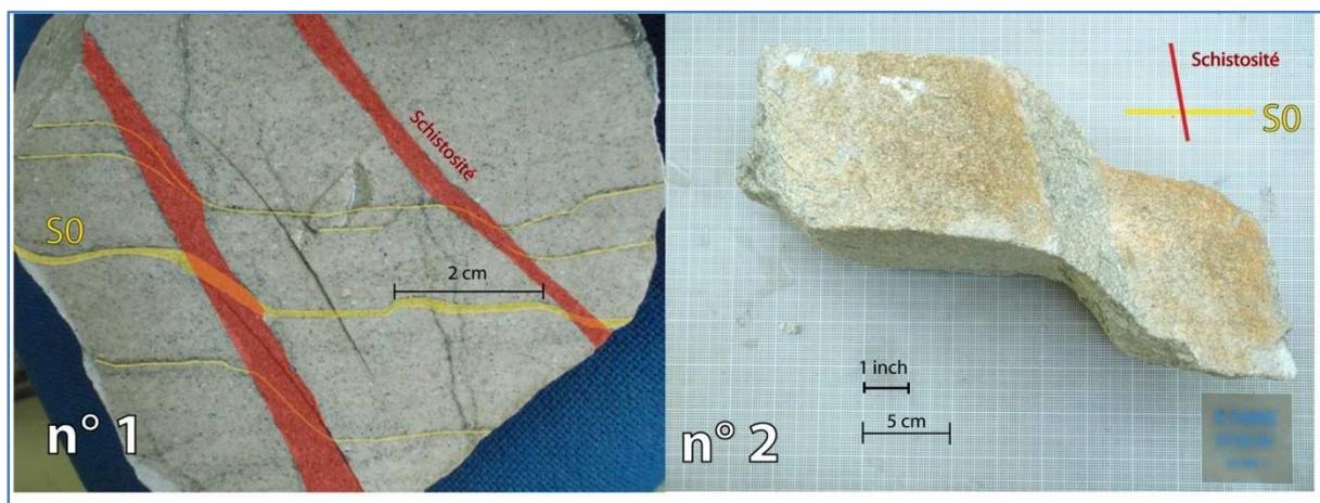
**Fig 3.10 : Échantillons de la schistosité des Gâts**
