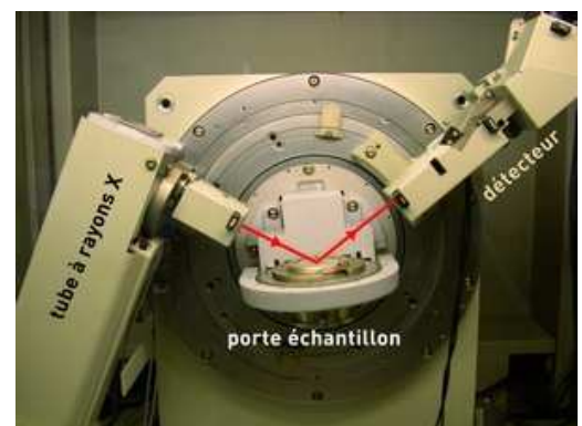
Appareillage et positionnement des éléments
