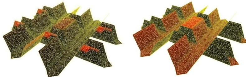
Figure 61 : Modèle type Plot d'angle d'inclinaison des façades 25°, de densité urbaine 50% et de hauteur 20m. Descripteurs affichés : à gauche, énergie réfléchié vers le ciel le 21_06 à 5H. A droite, énergie réfléchié vers le ciel le 21_06 à 12H
