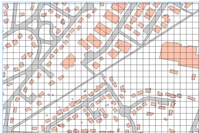
Figure 37. Intersection des mailles du MNT et les couches de bâtiments (en orange) et surfaciques de voies (en gris)
