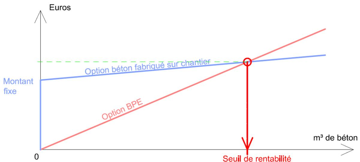
**Figure 13 : seuil de rentabilité d'une centrale à béton**
