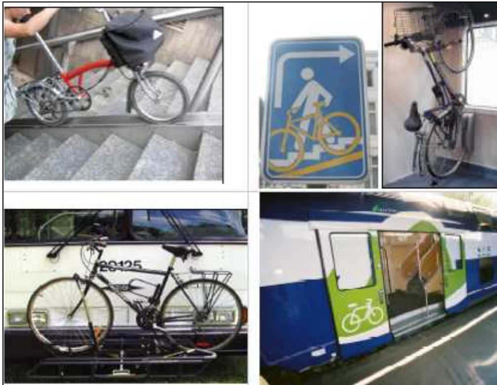
Figure 12 : Photos des différentes solutions mises en place pour favoriser l'intermodalité « train+vélo » (Métro de Bruxelles, train parisien et bus Montréalais)
