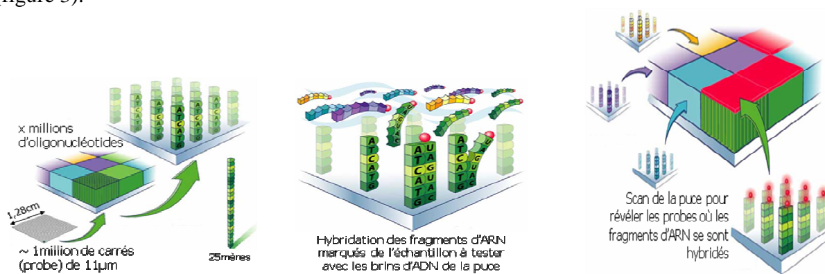
Figure 3 : Principe d'une puce : une séquence d'ADN va servir de sonde (probe) pour capturer son brin complémentaire dans un mélange d'acides nucléiques
