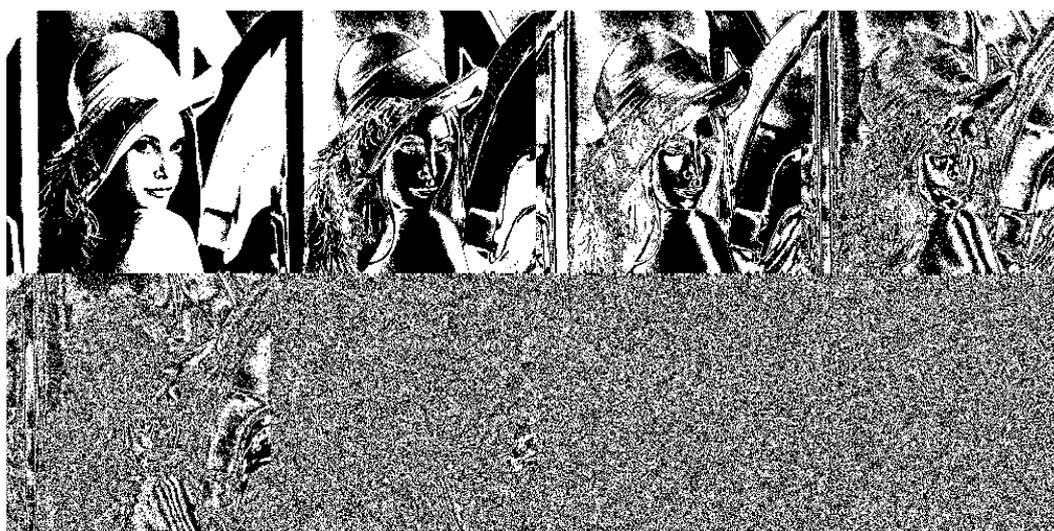
FIGURE 13 – Décomposition en « plans de bits » de l'image Lena (poids fort en haut à gauche, poids faible en bas à droite). Les plans des deux derniers LSB semblent visuellement très peu corrélés à l'image originale (source : [10]).
