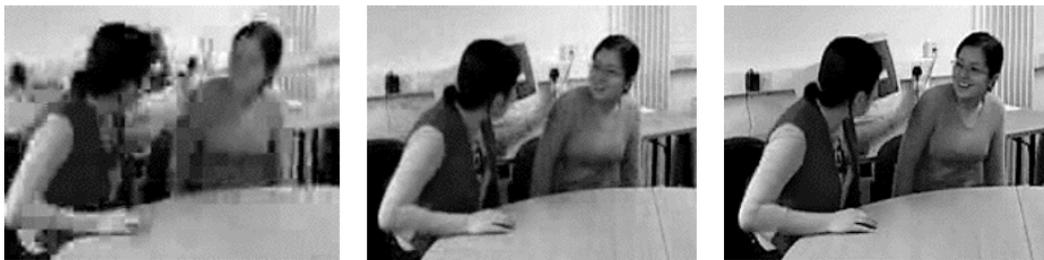
FIGURE 8 – Une image extraite d'une vidéo compressée à même débit au format MPEG-2 (à gauche), MPEG-4 Visual (au centre) et H264 (à droite). Source : [3].
