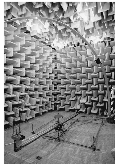
Fig. 4 – Montage de mesure polaire sur un hémisphère en chambre anéchoïque, University of Salford (ISO 17497-2).
