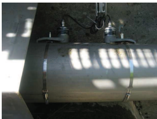
Figure 29 : Débitmètre à ultrasons posés sur le siphon de la prise d'eau de l'Aiguette (GU Aude-Tech)
