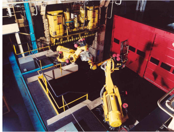
Figure 7: Ligne TGP automatisée
