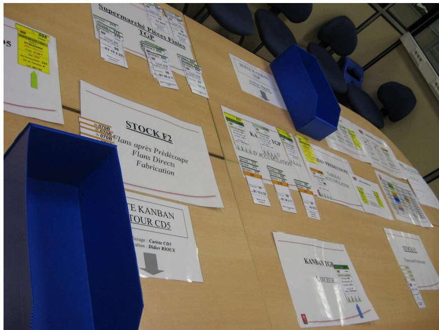
Figure 33: Jeu Kanban : simulation de fonctionnement de l'atelier en flux tiré
