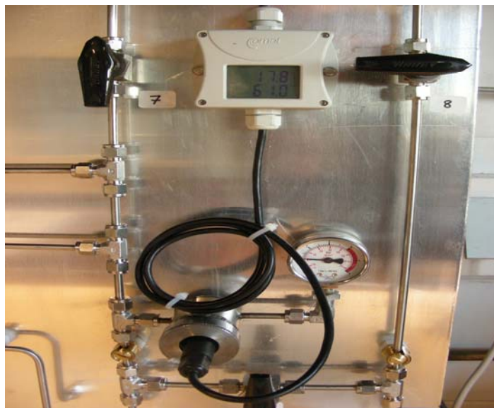
Figure 2.26 : Positionnement du thermo-hygromètre (sonde et afficheur), ainsi que le manomètre du réseau gaz.
