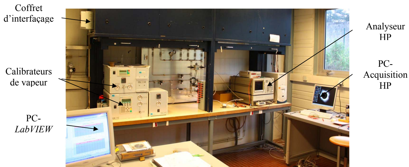
Figure 4.12 : Banc complet de mesure dans la salle « réseau gaz »
