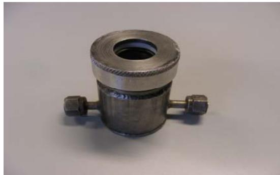
Figure 2.8 : Support en acier pour sonde thermo-hygrométrique, avec un diamètre d'insertion de 22mm.
