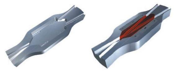
Ces deux images présentent le cœur d'aiguille développé par BWG. A gauche, le bloc de croisement fixé dans le sol, à droite en rouge le cœur d'aiguille amovible aisément remplaçable<sup>26</sup>.
