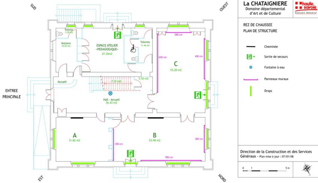
REZ-DE-CHAUSSEE - Plan intérieur - Indications des panneaux MDF
