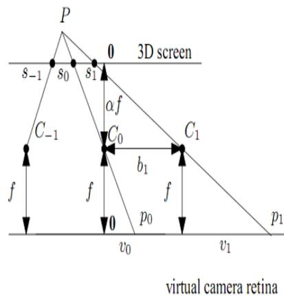
FIGURE 3.3.2: Les coordonnées d'un point dans l'écran 3D
