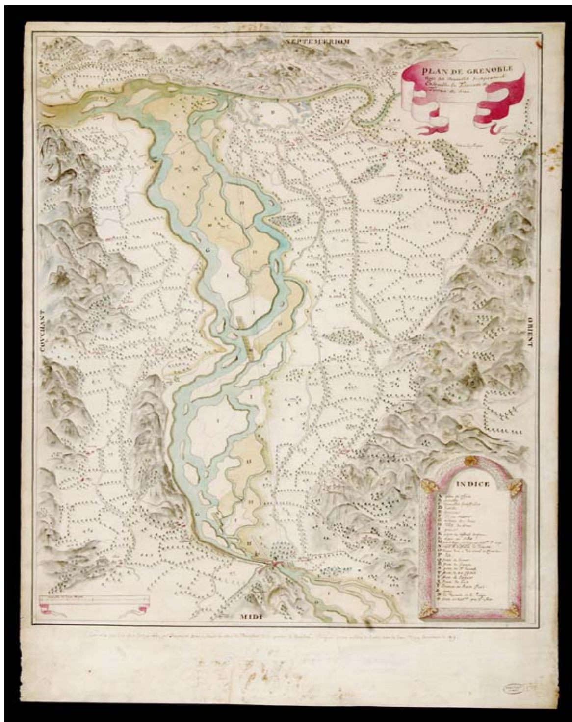
Plan de l'ingénieur Savoye et les travaux entrepris pour se garantir des débordements du Drac, 1660
