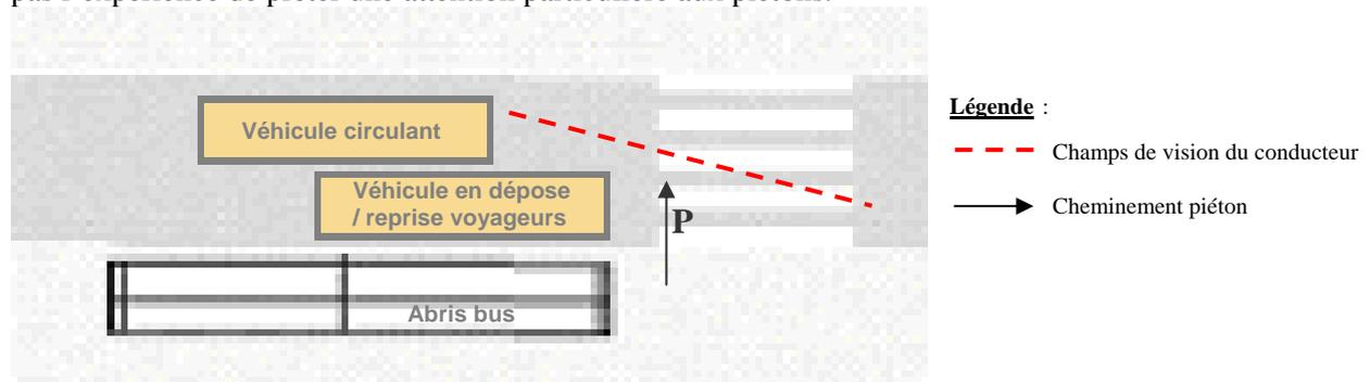
Illustration 17 : Non respect de la distance minimum entre un passage piéton et un abri bus
