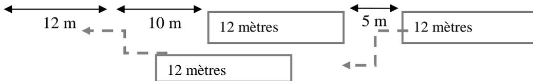
Illustration 24 : Distances minimales pour les manœuvres des véhicules
