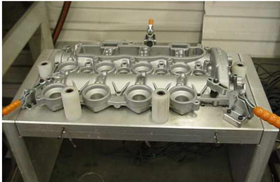
Figure 45: Moyens de contrôle planéité manuel
