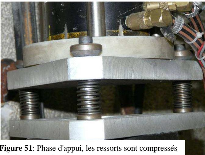
**Figure 51:** Phase d'appui, les ressorts sont comprimés sur plusieurs millimètres
