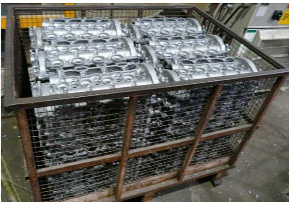
Le produit en sortie d'îlot de moulage devient : une grille de pièces prête au transport avec chariot élévateur, pièces dont l'écart de planéité est garanti en-dessous d'un seuil.
