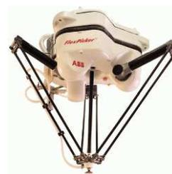
**Figure 7:** Robot structure parallèle
