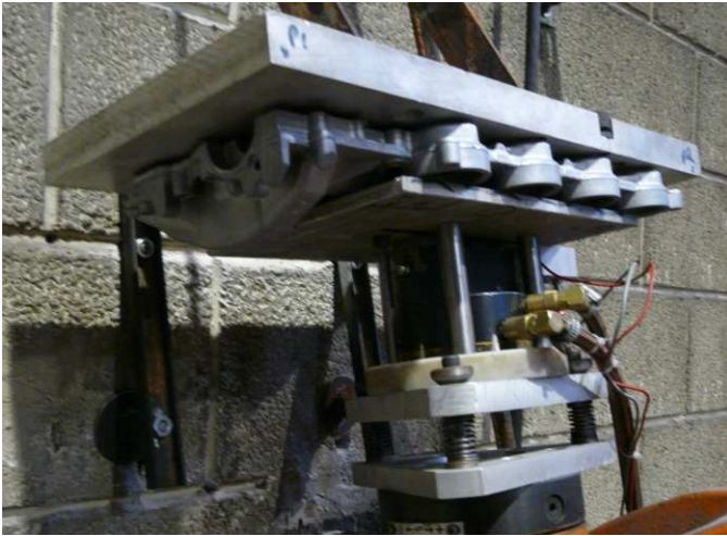
Figure 49: Plaquage et appui de la pièce avec le bras robotisé
