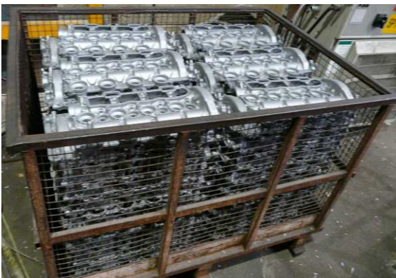
Figure 5: Grille remplie de pièces dont la planéité est garantie
