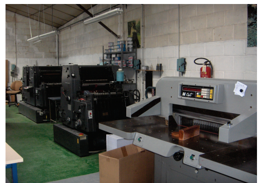
Illustration 3: Vue des 2 machines offset et du massicot
