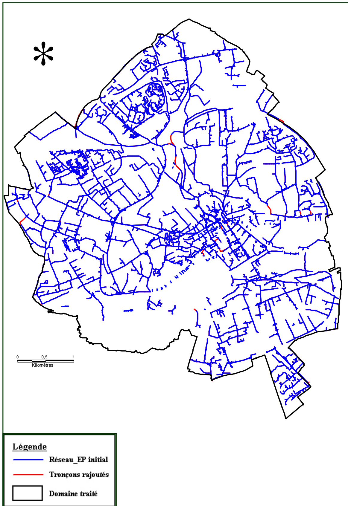
Figure 1 : Tronçons rajoutés dans le réseau d'assainissement
