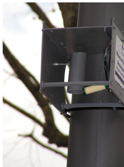
Figure n°2 : Capteurs placés lors des campagnes par échantillonnage passif
