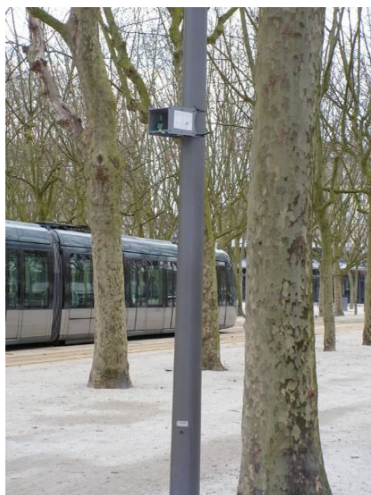
Figure n°2 : Capteurs placés lors des campagnes par échantillonnage passif
