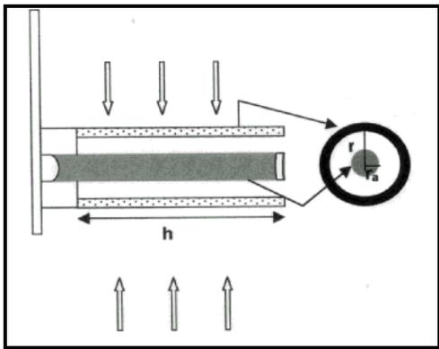
Les tubes « Radiello » sont des tubes à diffusion radiale, ce qui permet d'obtenir une surface de diffusion plus grande. Selon Radiello, cette technologie assure une meilleure sensibilité des mesures grâce à une augmentation de la masse captée.
