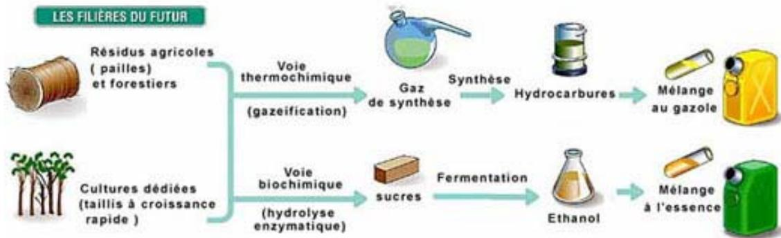
Figure 16 : Production de biocarburants de seconde génération - source IFP :
