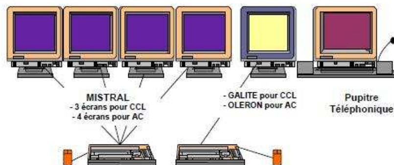
Figure 8 : Présentation de l'équipement d'un poste MISTRAL (RFF/SNCF)
