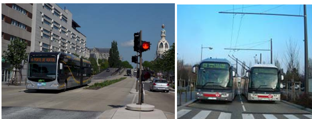
Figure 19 : Mode BHNS en modes thermique (Nantes) ou électrique (Lyon). Source : TTK
