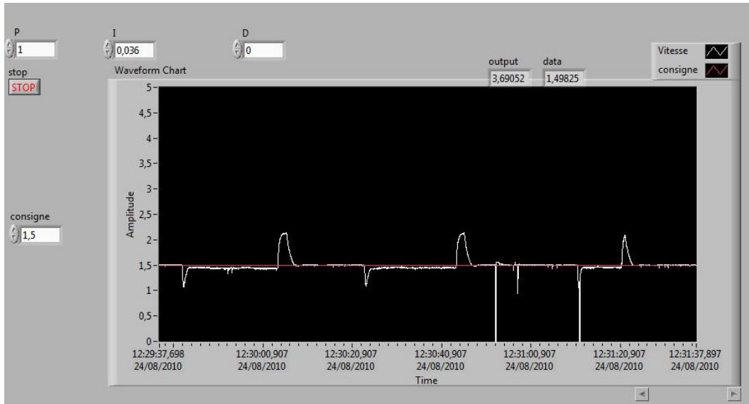
Fig VII. 17 Essai asservissement de la vitesse de MCC en charge.
