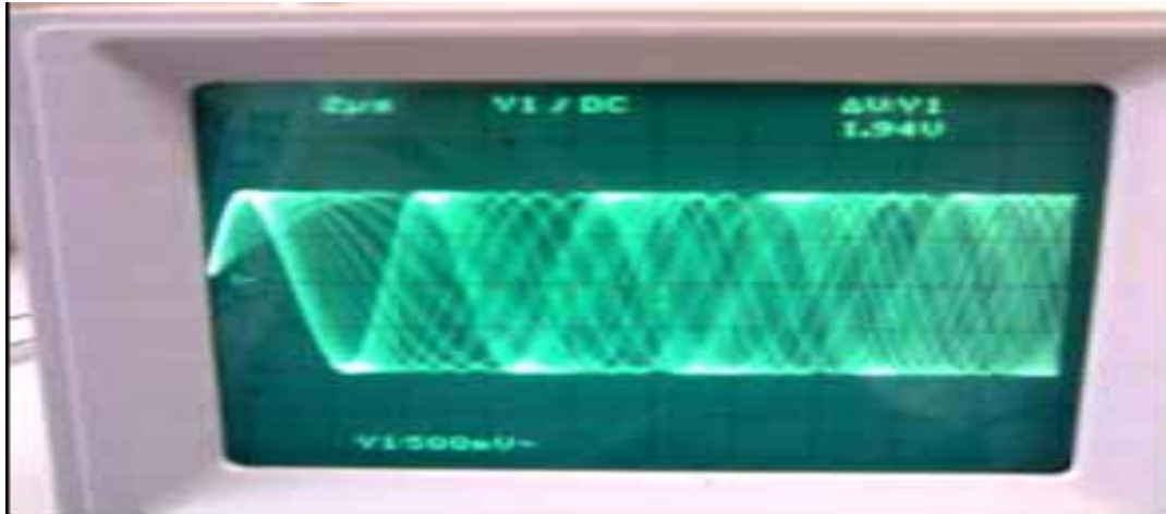
Figure(IV.3.3.3.2.aa): Représentation en temps des porteuses de brouillage
