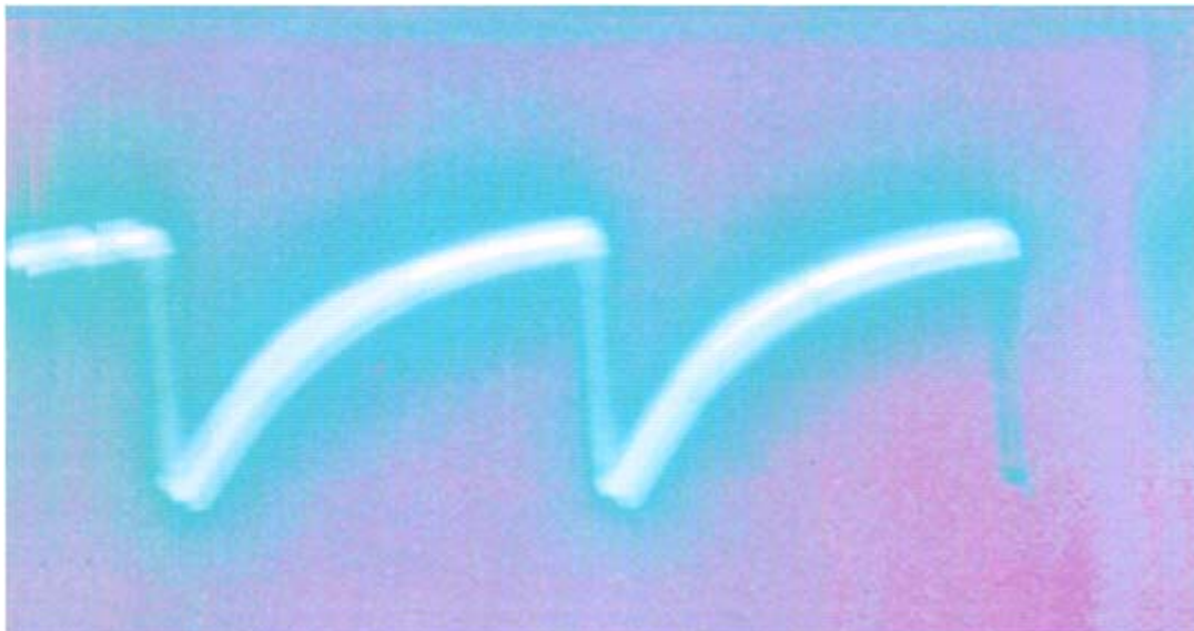
Figure(IV.3.3.3.2.2): Signal à l'entrée du VCO Pin3.
