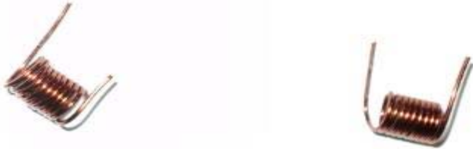
Figure(III.1.1.3): Bobines enroulées pour la détection GSM.
