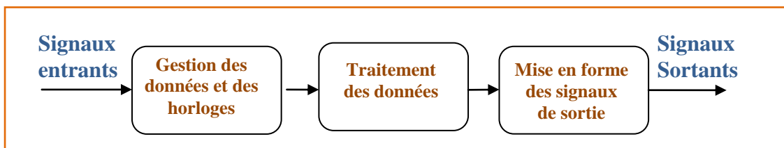
Figure 44 : Structure de la conception des filtres
