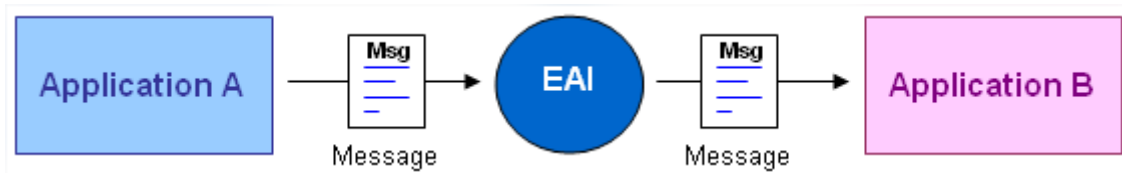
Illustration 10: Communication asynchrone au travers d'un intergiciel EAI.
