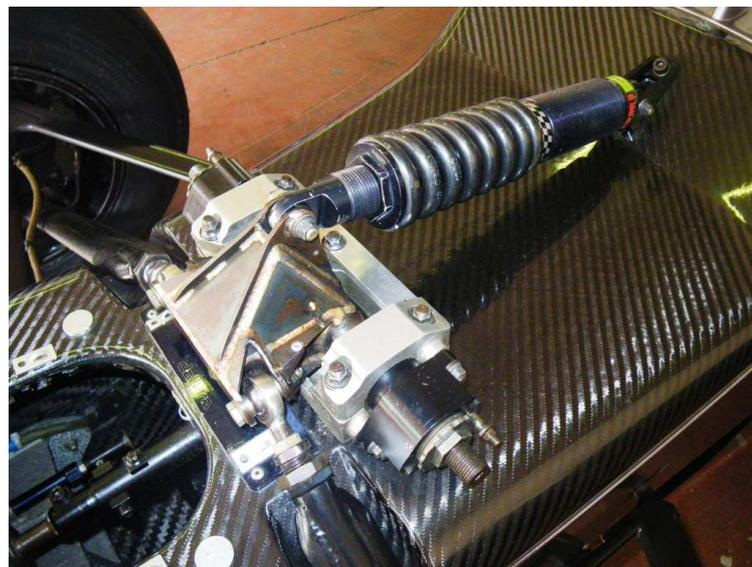
Figure 14 : Système anti-roulis avant
