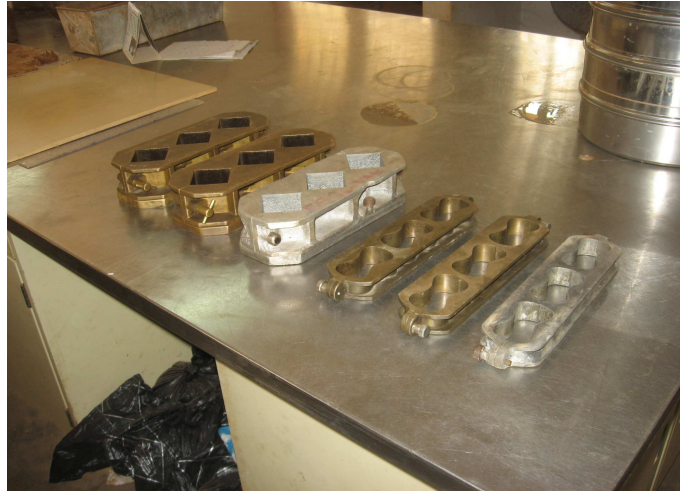
Figure 2.28 : Photo des moules <forme cubiques de 5cm de côté> et<Forme 8> permettant de réaliser 3 éprouvettes.
