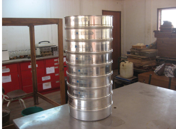
FIGURE 2.3 : Photo de la série de tamis normalisés ayant servi pour essais de laboratoire
