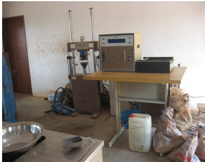
Figure 2.29 : Photo de la machine d'essais de résistance à la compression sur éprouvettes de mortier <Forme cubique>
