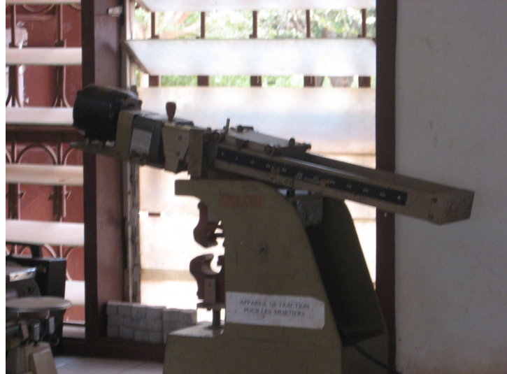
Figure 2.30 : Photo de la machine d'essais de résistance à la traction sur éprouvettes de mortier <Forme 8>
