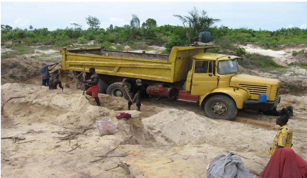
Figure 2.1 : Photo d'un camion engagé dans la tranchée de la carrière de terre ferme de Ahuikodji pour un chargement manuel.
