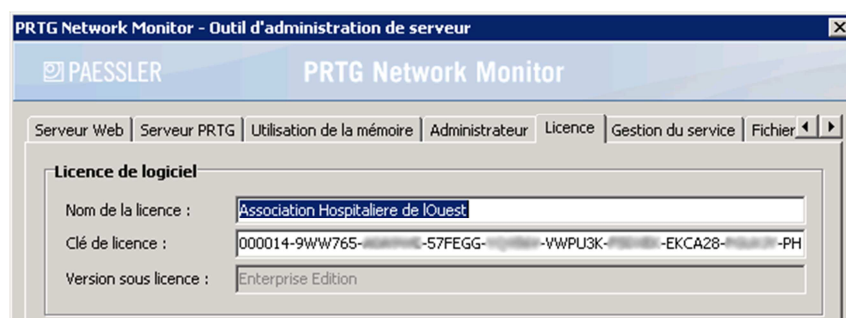
Figure 56 : Paramétrage de la licence PRTG Network Monitor
