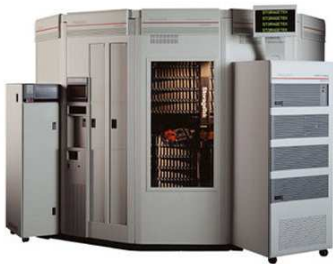
Figure 4: Exemple de robot de sauvegarde (Storagetek)
