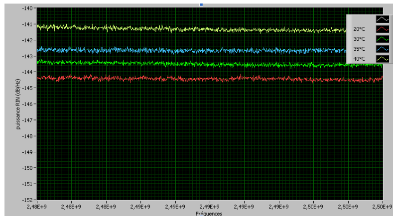
Figure 3-11 : évolution du RIN en fonction de la température du VCSEL
