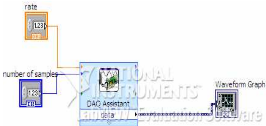
Figure 2.8: bloc diagramme avec le DAQ.
